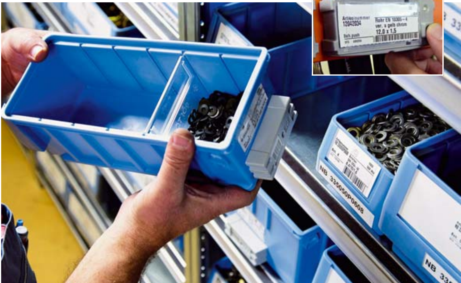
RFID-gesteuerte Logistiksysteme: turnLOG (großes Foto) für kleine und pushLOG (kleines Foto) für große, sperrige Teile
